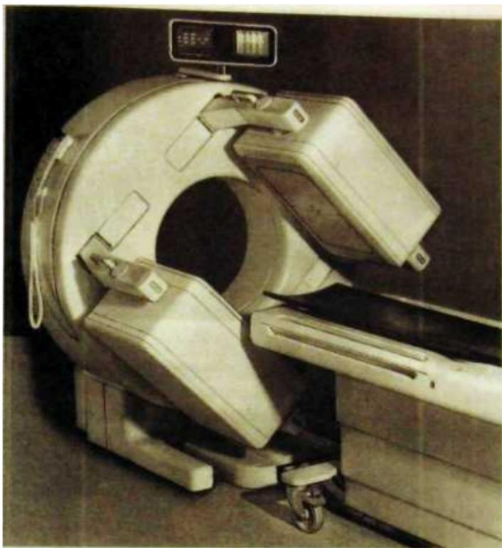
**Рис. 11.32.** Ротационная гамма-камера для эмиссионной томографии.
